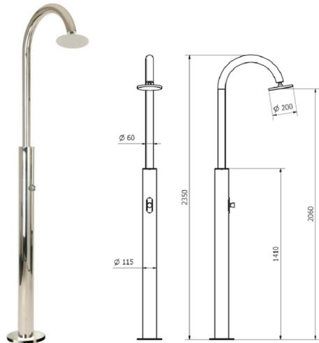
38928 **Kalt-Standbrause "ROMEO EXCLUSIV", V4A-SV** mit Selbstschlussventil fix eingestellt auf 15 sek., Anschluss von unten flexibel 1/2" I.G., schöner Regenwaldduschkopf D 200 mm, V4A-Standrohr D 115/60 mm hochglanz poliert
